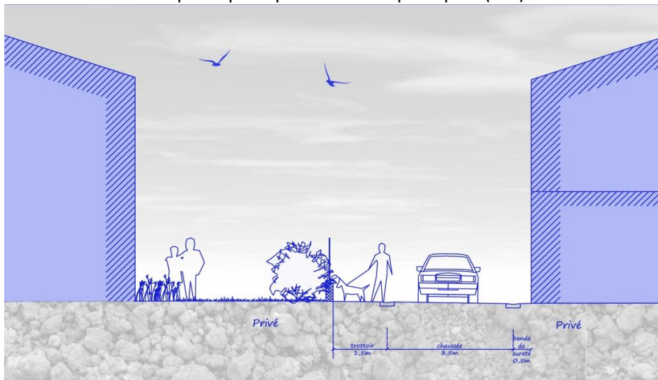
Coupe de principe du cheminement piéton (BB')
