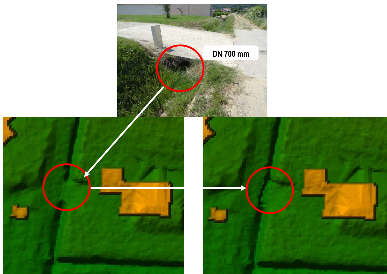
Figure 5 : Modification du modèle numérique de terrain utilisé pour la modélisation (données LIDAR)
