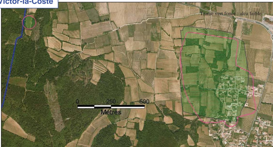
**Figure 41 : Comparaison entre le tracé de l'aléa tassement initial (contours roses) et l'aléa après sondage - Commune de Saint-Victor -la-Coste**
