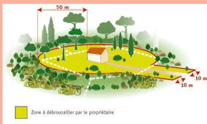
*Schéma type de l'application du débroussaillage réglementaire autour d'une construction et de sa voie d'accès privé*
